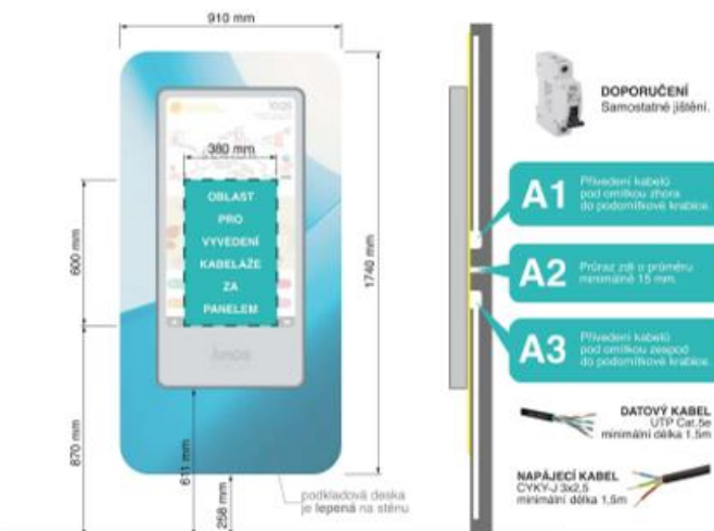
VARIANTA A kabely vyvedené za panelom
